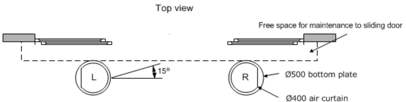
COMPACT400 hat einen fixen Ausblaswinkel von 15°. Die speziell geformten Bodenplatten ermöglichen ein Verstellen des Winkels auf bis zu 30°
